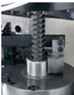
MQLブローチ加工 MQL Broaching 環境にやさしい植物油を ミスト化することで、 微量給油での加工を実現
