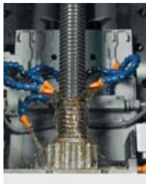
従来加工 Conventional 塩素分を多量に含有する 油性クーラントを大量に使用
