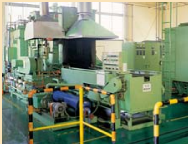
クイックマスター炉 (多目的雰囲気処理炉) MULTI PURPOSE QUICK MASTER
