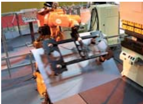
▲ 既設のプレスブレーキにロボット追加設置 Additional robot to previous press brake
