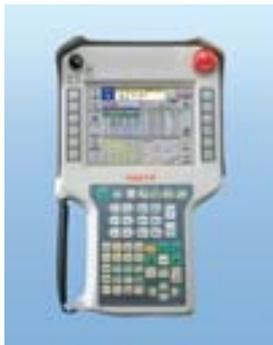
AXコントローラ内蔵型アプリケーションなので、画像処理およびプログラミングは、全てロボットティーチペンダントから簡単操作。
