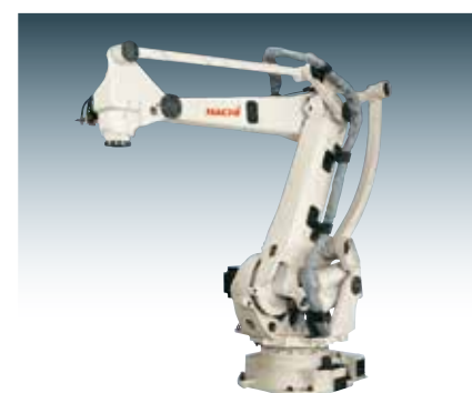
パレタイジングロボット LP130F/180 ダンボール箱から袋物、ビン、金属製品まで 高速・高精度にパレタイズ
