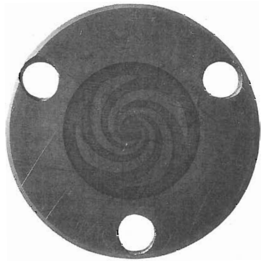
図15 コイニング加工例
