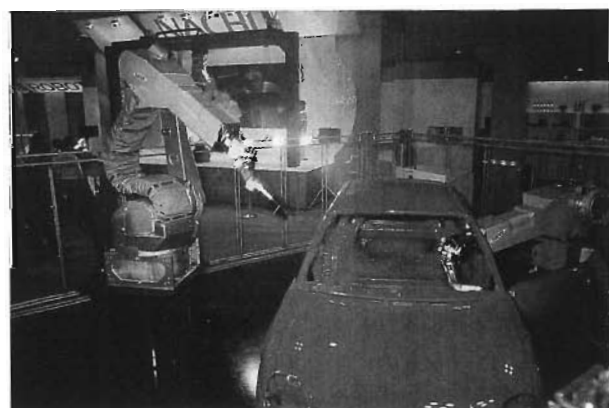
写真6 塗装機器／ホース内蔵の新型ロボット PWシリーズによる外板／内板塗装のデモ
