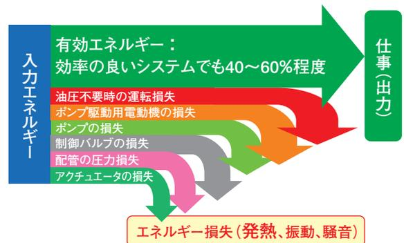
図2 油圧システムのエネルギー損失
