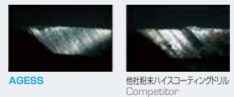
1149穴加工後の損傷状態を比較
