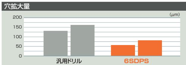
■切削条件 工具:φ6.0 被削材:S50C 電気ドリル使用
