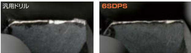
■切削条件 工具:φ3.5 切削速度:20m/min 送り速度:127mm/min 被削材:S50C M/C使用
