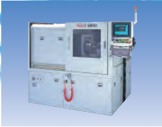
油圧静圧スライドを利用した超精密非球面加工機
