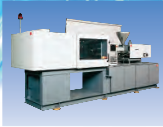
油圧機器が使用されている射出成形機
