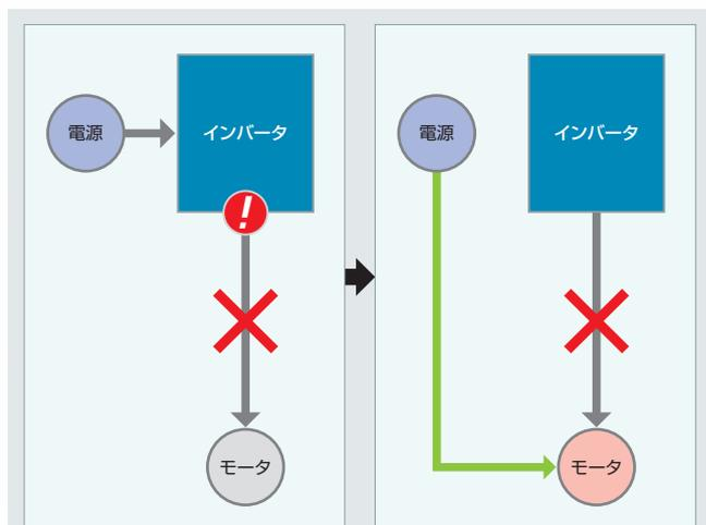
インバータのトラブルでモータへの電力供給がストップした状態。このままではラインが止まってしまいます。
