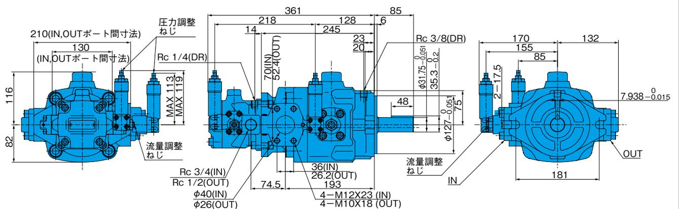
注) 1. VDC-\*A\*はB-26ページのフットマウンティングキットを取付けています。
