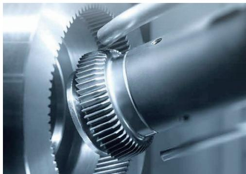
歯車は多くの産業を支える重要な機械要素のひとつであり、回転運動により確実かつ高能率に動力を伝達する。ギヤスカイビング加工は、クーラントを使用しながらの断続切削の熱衝撃で刃具寿命が短くなり、ランニングコストの面で課題があった。熱衝撃を避けるにはドライ加工が不可欠で、そのため切りくず噛み込みを防止する加工技術とカッターには耐熱性と耐摩耗性が求められる。
