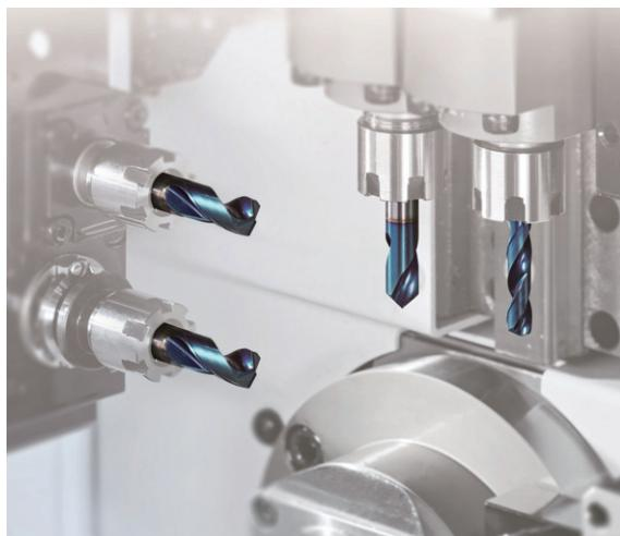
CNC自動旋盤は、長尺の棒材から連続して部品を削り出し、切り離す加工が可能であり、自動化・省人化など、高い生産性を実現できることから、幅広い分野で利用されています。
