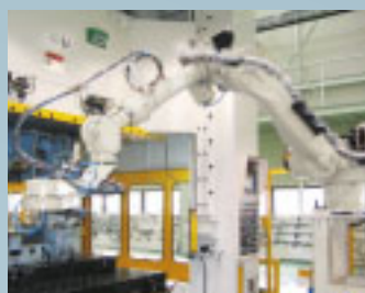
プレス工程搬送
