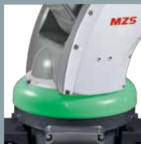
挟まれリスクを低減するストップカバー にはLEDランプが内蔵され、ロボットの稼働状況を色と点滅、ブザー音で確実に伝えます。
