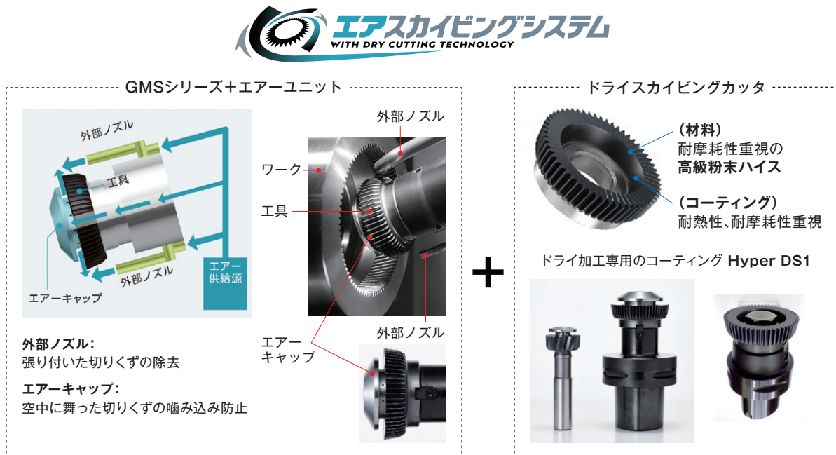
図13 「エアスカイピングシステム」の構成
