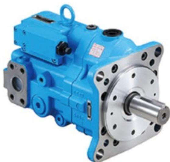
ものづくりの工程では、切削加工と並んで塑性加工が多用され、その塑性加工を行なうのが鍛圧機械です。鍛圧機械がワークを押し出す力(推力=油圧シリンダの面積×圧力)を高めるには、高圧化もしくは油圧シリンダを大きくする必要があります。ものづくりの現場においては、省エネルギー・コンパクト化がますます進んでおり、鍛圧機械も例外ではありません。不二越は、鍛圧機械のコンパクト化を可能にする高圧可変容量形ピストンポンプPZH-3Bを開発しました。
