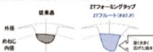
切削油剤が先端まで入りにくい横形M/Cでも、加工点まで確実に油剤を供給
