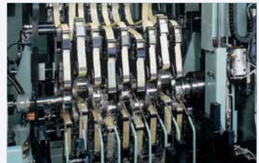
パワーフィニッシャ クランクシャフト カムシャフトをラッピング加工
