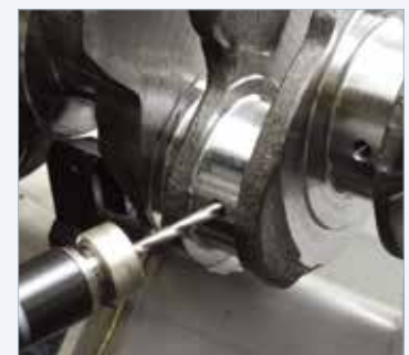
MQLパワーセル MQL加工システム 深穴の高効率ノンステップ加工
