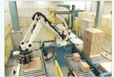
パレタイジングロボット LPA180 ダンボール箱から袋物、ビン、金属製品まで 高速・高精度にパレタイズ
